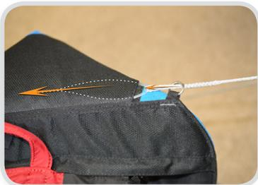
Faites passer la ligne d'accélérateur par le maillon métallique puis à travers la manche de protection en s'aidant d'une tige en plastique si nécessaire. Enfin, passez la ligne dans la poulie Ronstan.
