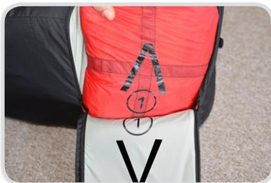
Positionner soigneusement la poche de déploiement dans le conteneur en faisant coïncider le ① et la flèche sur la poche du secours avec ceux du rabat. Les suspentes du parachutes doivent être du côté haut.
