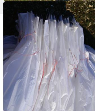
**Paso 4.** Agrupa el centro/borde de fuga de la vela ordenando los pliegues cerca de los puntos de anclaje de las B, C y D.
