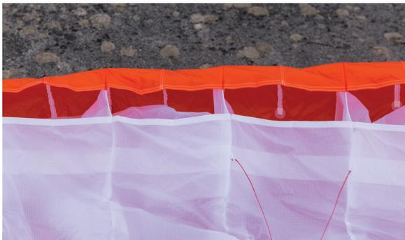
**Les jongs en nylon ne sont plus seulement au niveau des cloisons du bord d'attaque, mais aussi au centre des caissons.**
