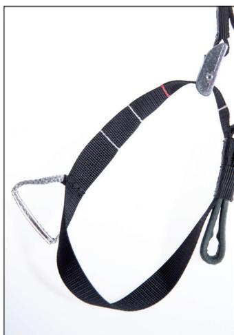
**Ci-dessus : Les élévateurs ne sont pas encombrés.** Ils sont simples et efficaces. Une unique hauteur d'accrochage aux mousquetons, mais la hauteur de la poulie de frein est réglable. Poulie de 20 mm avec roulements à billes pour l'accélérateur.
