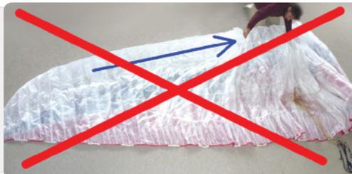
**IMPORTANTE:** No pliegues la vela por el centro, pues así doblarás las varillas. En lugar de ello, pliégalas cajón por cajón de establero a establero antes de meterla en su bolsa.
