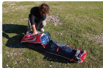
**IMPORTANT:** N'étalez pas votre voile à plat sur le sol avant de la regrouper en accordéon, cela risquerait à la longue de causer des dommages par abrasion sur le tissu de l'extrados, au niveau des renforts plastiques. Toujours rassembler sa voile en bouchon avant de commencer le pliage en accordéon du bord d'attaque.
