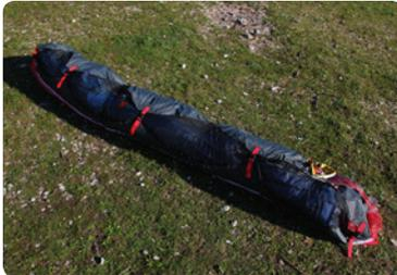
**Schritt 9** Drehe die Sausisse auf die Seite und falte den Schirm zum ersten mal nach den Verstärkungen der Anströmkante. Falte nicht die Plastikverstärkungen. Falte den Schirm 3 oder 4 mal um die Anströmkante herum.
