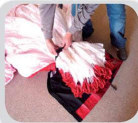
**Step 4.** Groupez les nervures du milieu d'aile, en rassemblant les pattes B.
