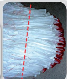
**Step 6.** Faites le premier pliage au bout des renforts avants. Ne pas plier les renforts plastiques. Replier en 3 autour du bord d'attaque.
