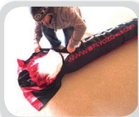
**IMPORTANT: N'étalez pas votre voile à plat sur le sol avant de la regrouper en accordéon, cela risquerait à la longue de causer des dommages par abrasion sur le tissu de l'extrados, au niveau des renforts plastiques. Toujours rassembler sa voile en bouchon avant de commencer le pliage en accordéon du bord d'attaque.**
