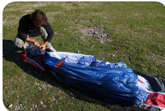
**Etape 8.** Mettez en place le coussin de pliage et pliez le bord d'attaque autour de ce dernier. Faites trois plis.
