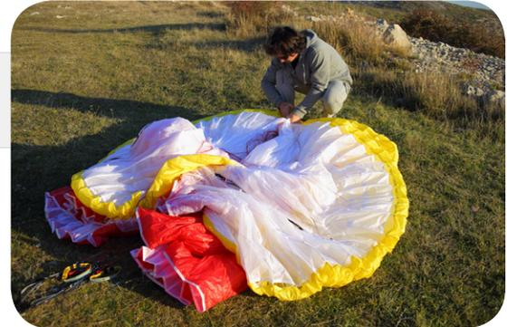
**Etape 3.** Parfaire le pliage en accordéon du milieu de l'aile puis du bord de fuite, en rassemblant les pattes des B et des C.
