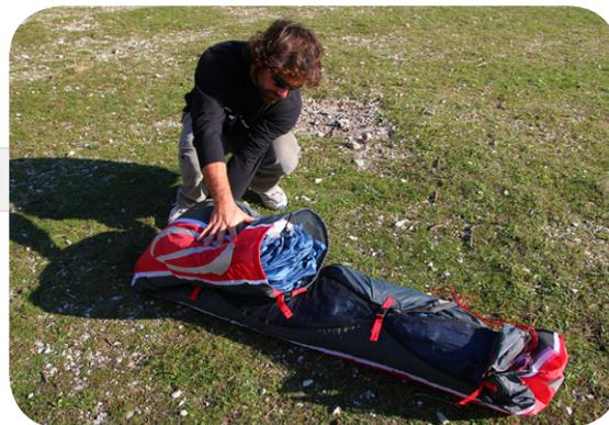
**IMPORTANT:** N'étalez pas votre voile à plat sur le sol avant de la regrouper en accordéon, cela risquerait à la longue de causer des dommages par abrasion sur le tissu de l'extrados, au niveau des renforts plastiques. Toujours rassembler sa voile en bouchon avant de commencer le pliage en accordéon du bord d'attaque.
