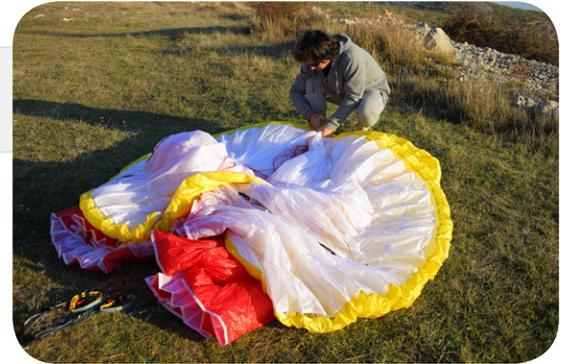
**Paso 3.** Agrupa el centro y el borde de fuga de la vela ordenando los pliegues cerca de los puntos de anclaje de los cordinos B y C.
