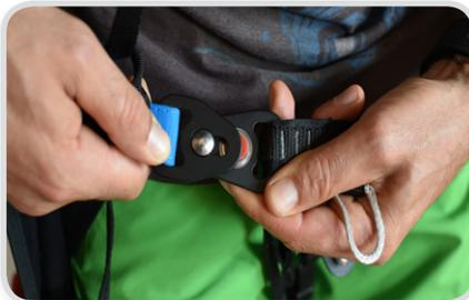
Les sangles de cuisses/ventrale se bouclent avec les boucles déclick. On doit presser le bouton rouge pour fermer ou ouvrir les boucles. Engagez le trou sur le bossage argenté de façon à appuyer sur le bouton rouge, puis faites glisser la boucle vers l'arrière. Le bouton rouge est alors libéré et la boucle est verrouillée.
