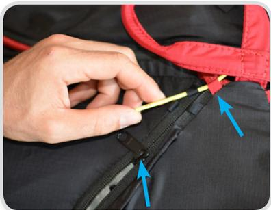
Poussez les deux fermetures Eclair le plus près possible de la bride du parachute. Puis repartez dans l'autre sens pour fermer le conteneur. Ne fermez pas encore complètement le conteneur, poussez les fermetures juste assez loin pour approcher les oeillets.
