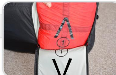
Maintenant, plier le rabas de la poignée de la poche de déploiement le long des pointillés de façon à mettre la pointe de la flèche dans le prolongement de sa base.
