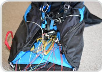
Toutes les boucles, les mousquetons, les élévateurs et les sangles de la structure doivent être placés du côté intérieur de la structure de la sellette, alors vous pouvez replier la sellette en deux de façon à avoir le parachute de secours sur le dessus.
