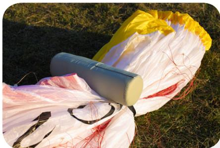
**Schritt 5** Lege die Schaumstoffrolle hinter die Anströmkante – auf die erste Faltung. Das verringert den Winkel der Faltung und schützt die Plastikverstärkungen. Danach faltest du die Hinterkante vorsichtig und nicht zu eng um die Anströmkante.
