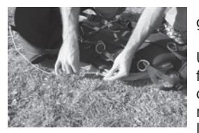
Stelle sicher, dass die Leinen der Speedbar gleich lang sind, und vergewissere dich gründlich, dass sie auch nicht zu kurz sind, da dies den Beschleuniger unbeabsichtigt aktivieren könnte, wenn die Leinen in der Luft unter Spannung geraten.
