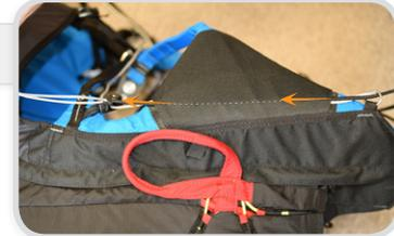
**WICHTIG:** Stelle sicher, dass die Beschleunigungsleinen gleich lang sind, und vergewissere dich gründlich, dass sie auch nicht zu kurz sind, da dies das Beschleunigungssystem unbeabsichtigt aktivieren könnte, wenn es in der Luft unter Spannung gerät. Überprüfe das nochmals am Boden, bevor du fliegst.
