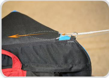
Führe die Leine des Beschleunigers durch den Metallring und die Öffnung der Schutzhülle – benutze ein Stück Plastik oder eine Hilfsleine um durch die Öffnung zu finden. Dann führe die Leine durch das Ronstan Röllchen.
