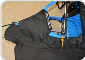
Verbinde den Beschleuniger mit der Beschleunigungsleine und der Gummileine mit einem geeigneten Knoten. Wenn du dann in der Luft bist, und es sicher ist, überprüfe, ob du deinen Fuß einfach auf den Beschleuniger setzen kannst, und das System den gesamten Geschwindigkeitsbereich hindurch bis zur Höchstgeschwindigkeit leichtgängig funktioniert.
