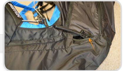
Vergewissere dich, dass die Klemme geöffnet ist, und befestige den Schlauch am Ausgang des Gewebesacks (Blasebalgs).
