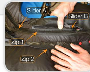
Verbinde SLIDER B mit ZIP 2 und schließe die Bahn vollständig. ZIP 2 geht um das gesamte Gurtzeug herum.
