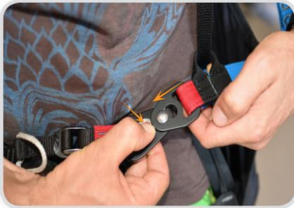
Um die Schließen wieder zu öffnen, musst du zuerst den roten Knopf herunterdrücken, und die Schließe dann nach vorne schieben.
