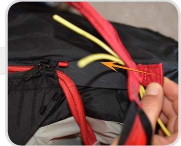
Jetzt fädelt du die gelben Sicherheitspins durch die Pin-Ösen. Beginne mit dem Pin, der sich nahe an der Gabelleine befindet. Jeder Pin beginnt immer mit einer roten Öse. Fädle den Pin der Reihe nach durch jede Öse, und vergewissere dich, dass du nicht aus Versehen eine übersiehst.
