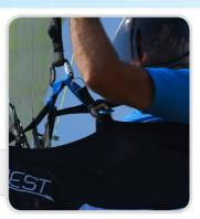
Il n'y a pas d'autre point de connexion souhaitable pour les élévateurs sur la sellette.
