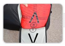
Positionner soigneusement la poche de déploiement dans le conteneur en faisant conïcider le ① et la flèche sur la poche du secours avec ceux du rabat. Les suspentes du parachutes doivent être du côté haut.
