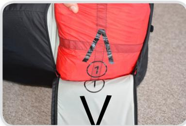
Platziere den Innencontainer im dafür vorgesehenen Fach mit dem weißen Pfeil ① am Griff des Innencontainers in Richtung Außenseite zeigend, so dass es zum weißen Pfeil im Gurtzeug passt. Die Leinen zeigen nach außen, und der Griff ist wie gezeigt korrekt positioniert. Die Leinen des Retters sollten sich ganz oben befinden.
