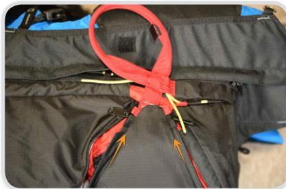
Schließe beide Reißverschlüsse in Richtung der Verbindungsleine des Retters soweit es geht. Dann ziehst du die Reißverschlüsse in die andere Richtung, so wie man den Container schließen würde. Schließe den Container jetzt noch nicht vollständig, sondern schließe die Reißverschlüsse gerade so weit, um die Pin-Ösen an ihrer Position zu sichern.
