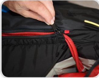
Stelle sicher, dass die Gabelleine des Gurtzeugs wie gezeigt korrekt in den Rettungsschirm Container führt. Vergewissere dich, dass der ZIP 2 ganz geschlossen ist.
