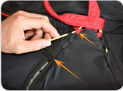
Führe das gelbe Plastik durch die Ösen – die roten Ösen zuerst. Vergewissere dich, dass beide Pins auf jeder Seite des Containers korrekt gesichert sind.
