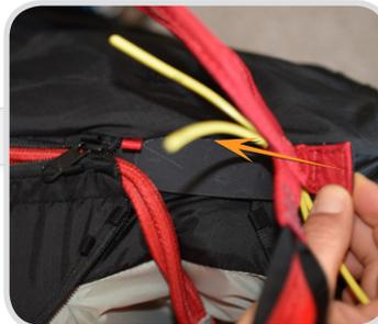
Jetzt fädelst du die gelben Sicherheitspins durch die Pin-Ösen. Beginne mit dem Pin, der sich nahe an der Gabelleine befindet. Jeder Pin beginnt immer mit einer roten Öse. Fädele den Pin der Reihe nach durch jede Öse, und vergewissere dich, dass du nicht aus Versehen eine übersiehst.
