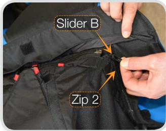
Beim Einbauen des Retters solltest du immer mit dem Gleitschirm Modul beginnen. Zuerst öffnest bzw. löst du SLIDER B / ZIP 2 komplett. Sie befinden sich vorne rechts am Gurtzeug.
