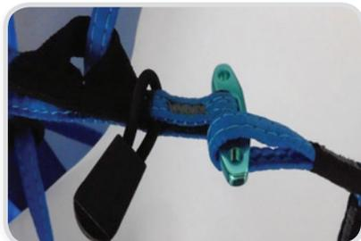
Abrocha las perneras y la ventral mediante las hebillas T lock ligeras. Pasa completamente la hebilla T lock por el bucle de cinta y fíjala en su sitio con el bucle elástico.
