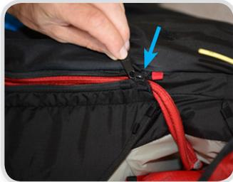
Stelle sicher, dass die Gabelleine des Gurtzeugs wie gezeigt korrekt in den Rettungsschirm Container führt. Ziehe den Reißverschluss, der die Gurtzeugretter-Gabelleinen sichert, bis zum Ende nahe des Rettungsschirm Containers.
