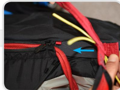
Jetzt fädelst du die gelben Sicherheitspins durch die Pin-Ösen. Beginne mit dem Pin, der sich nahe an der Gabelleine befindet. Jeder Pin beginnt immer mit einer roten Öse. Fädele den Pin der Reihe nach durch jede Öse, und vergewissere dich, dass du nicht aus Versehen eine übersiehst.
