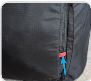
Jetzt kannst du den Rettungsschirm Container und das Gabelleinen-Fach vollständig schließen. Sichere die Reißverschlüsse innerhalb der Lasche. Am Container sind die Laschen rot gekennzeichnet, und am Verbindungsleinenkanal schwarz.
