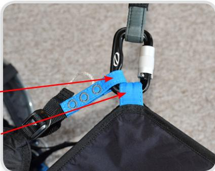
Verbinde die Tragegurte des Gleitschirms mit den Karabinern am Hauptaufhängepunkt. Die A-Tragegurte sollten nach außen schauen.
