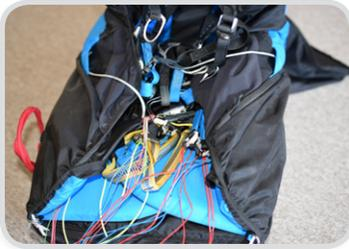
Stelle sicher, dass sich alle Schließen, Karabiner, Tragegurte und Gewebebänder auf der Innenseite des Gurtzeugs befinden. Dann faltest du das Gurtzeug zur Hälfte, so dass sich der Rettungsschirm ganz oben befindet.
