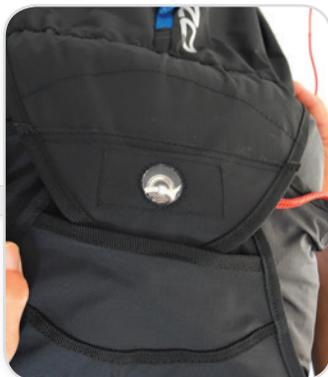
Fermer le tout en passant l'aiguille dans la boucle. Ne pas oublier de retirer complètement et délicatement la suspente, sinon les volets risquent de ne pas s'ouvrir.
