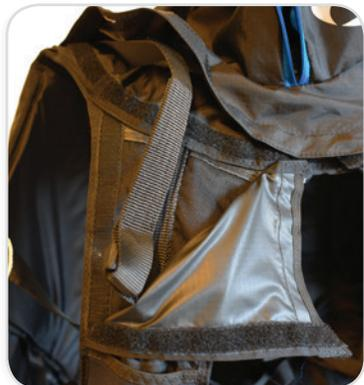
Les brides du secours sont intégrées au niveau des points d'accrochage d'épaules. Ouvrez le Velcro situé au sommet des sangles d'épaules et défaites les brides. Les deux brides doivent être passées par la manche protectrice latérale sur le côté où la poignée du secours doit être montée.
