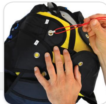
Sur le volet N°1, enfiler un morceau de suspente à travers la boucle et faire passer à travers l'œillet de chaque volet en ordre numérique.
