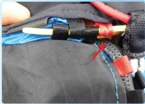
Jetzt musst du die 3 gelben Splinte durch ihre jeweilige Schlaufe führen. Beginne mit dem Splint, der auf die Rückseite des Gurtzeuges führt. Jeder Splint muss durch die Schlaufen geführt werden, und das in korrekter Reihenfolge: die rote Schlaufe zuerst. Wenn die rote Schlaufe und 3 kleinere schwarze Schlaufen gefädelt sind, dann platziere den Splint in der letzten Halterungsschlaufe.
