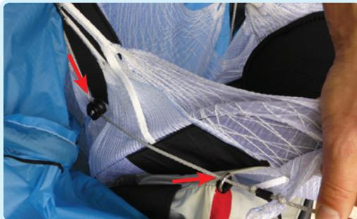
Führe die Leine durch das Ronstan Röllchen und dann den Ring, und vergewissere dich dabei, dass das Röllchen nicht verdreht ist. Stelle sicher, dass die Leinen glatt und sauber durch die Röllchen laufen, und sie auf der Innenseite aller Strukturgewebebänder verlaufen. Überprüfe nochmals, dass sich die Leinen nicht unbeabsichtigt um irgendein Gurtband gewickelt haben, ehe du sie mit dem Beschleuniger verbindest. Die Bar kann dann mit den Gummis mit der Fußplatte verbunden werden.
