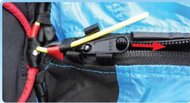
Der dritte Splint folgt der Richtung der Gurtzeug-Gabelleinen. Nach den ersten gemachten Schlaufungen ziehst du den Reißverschluss so, dass du die verbleibenden Schlaufen fädeln kannst.
