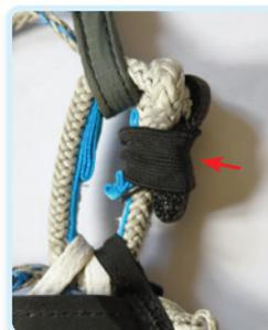
Sichere den Tab B mit elastischem Band
