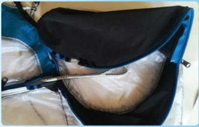
Stelle sicher, dass die Gurtzeug-Gabelleine, wie hier bildlich gezeigt, korrekt in den Rettungsschirm Container geführt wird.
