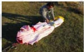
**Etape 5** Placez le coussin pliant derri  re le bord d'attaque. Ceci diminue l'angle des plis et aide    la conservation des renforts. Repliez ensuite le bord de fuite autour du bord d'attaque en   vitant autant que possible un pliage trop serr  .
