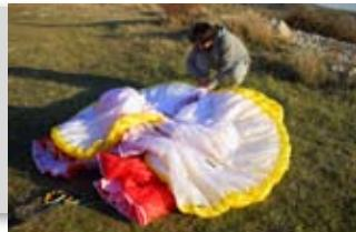
**Etape 2** Groupez les renforts de bord d'attaque avec les pattes A align  es. Notez que le parapente n'est pas regroup   en deux parties mais en une seule, d'un bout d'aile    l'autre. C'est tr  s important pour ne pas tordre les renforts plastiques des cellules centrales.
