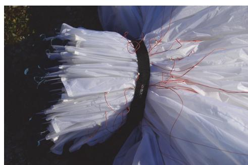
4. B, C, Dライン取り付けタブを利用してグライダーの中央から後方部分をひとまとめにします。
