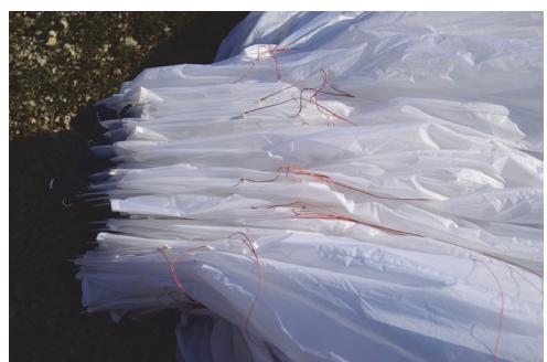
3. ひとまとめになったリーディングエッジをパッキングベルトで固定します。グライダーをセンター部分で半分に折り重ねずに、翼端から翼端まですっかり蛇腹折りにします。真中のセルを無理に引っ張ったりプラスティックパイプを変形させたりしないように慎重に行ってください。
