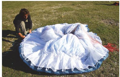
2. Aライン取付部を持って、プラスティックパイプが隣り合わせに重なるようにリーディングエッジ部分をひとまとめにします。
