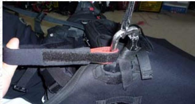
Connectez les clips de rétention (2) soit aux deux maillons, soit aux sangles de jambes ou à tout autre point fixe adapté. Cela maintiendra le sac de largage en position. Le sac ne doit pas être plus tendu que votre ventrale.
