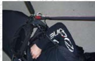
Nachdem der Griff befestigt ist, bleibt das Anti-G in hängender Position und produziert nicht länger einen signifikanten Widerstand.
