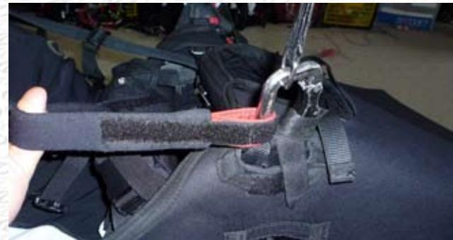
Befestige die verbleibenden Klips (2) entweder an beiden Karabinern, beiden Beingurten oder an einem anderen geeigneten und fixen Punkt. Das hält den Außenkontainer ordentlich an seiner Position. Der Außenkontainer darf nicht mehr Spannung haben, als der Brustgurt deines Gurtzeuges.
