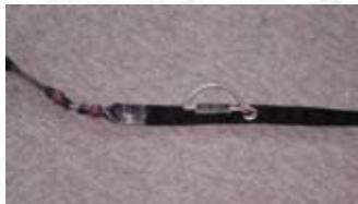
A mi-longueur de la sangle, juste sous l'émerillon, se trouve la poignée de la suspente centrale (3). L'action de tirer sur cette poignée permet de « déventer » le parachute et vous permettra d'effectuer votre approche d'atterrissage.
