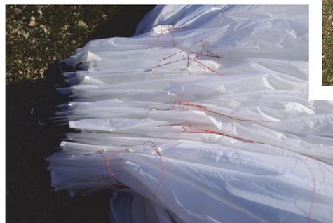
3. ひとまとめになったリーディングエッジをパッキングベルトで固定します。グライダーをセンター部分で半分に折り重ねずに、翼端から翼端まですっかり蛇腹折りにします。真中のセルを無理に引っ張ったりプラスチックパイプを変形させたりしないように慎重に行ってください。
