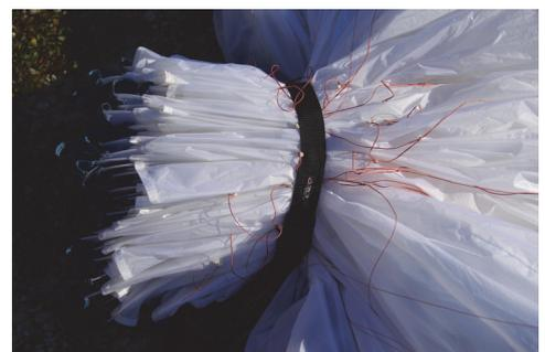
4. B、C、D ライン取り付けタブを利用してグライダーの中央から後方部分をひとまとめにします。
