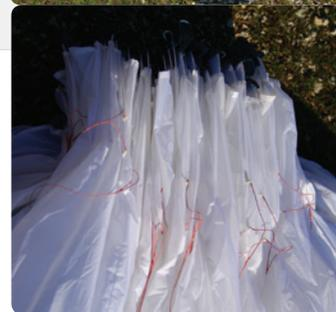
**Paso 4.** Agrupa el centro/borde de fuga de la vela ordenando los pliegues cerca de los puntos de anclaje de las B, C y D.
