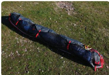
**Paso 9.** Pon de lado la Saucisse y haz el primer pliegue justo donde acaban las varillas del borde de ataque. No dobles las varillas. Pliéglala en 3 o 4 tramos.
