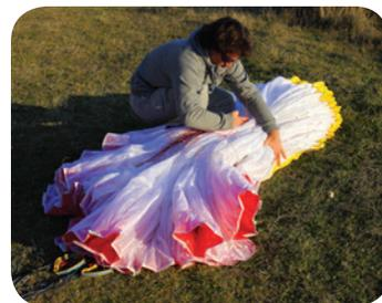
**Etape 3.** Groupez les nervures du milieu d'aile, en rassemblant les pattes B et C.
