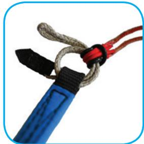
Stelle sicher, dass die Leinen und der Gummiring ordentlich mit dem Link Lite befestigt sind, frei sind von Eindreihungen und sich keine Schlaufen überlappen.
