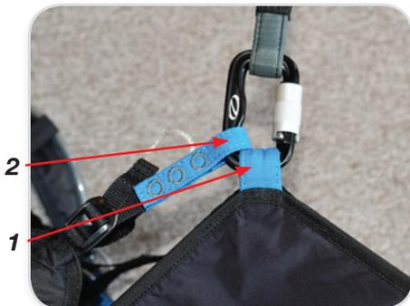
Conecta las bandas de la vela a los mosquetones de la silla. Las bandas A deben quedar mirando hacia el exterior.
