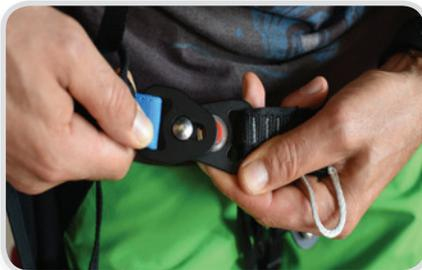
Cierra las perneras y la ventral con las hebillas automáticas. Para cerrar y abrir las hebillas automáticas hay que presionar el botón rojo. Introduce el tetón plateado por el lado circular de la ranura de la hebilla y deslízalo hacia atrás para que haga tope contra el extremo estrecho. El botón rojo emergerá y hará de tope con la hebilla hembra, con lo que el tetón no podrá desplazarse hacia atrás y salirse de la ranura.
