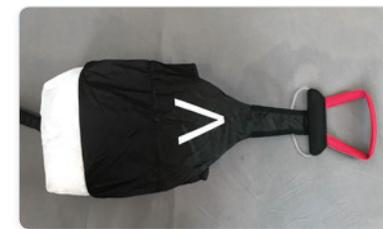
Öffne den Reserveschirm Container hinten am Gurtzeug, indem du die Reißverschlüsse öffnest. Platziere den Innencontainer im dafür vorgesehenen Fach mit dem weißen Bogen am Griff des Innencontainers in Richtung Außenseite zeigend, so dass es zum weißen Bogen im Gurtzeug passt. Die Leinen zeigen nach außen, und der Griff ist wie gezeigt korrekt positioniert.
