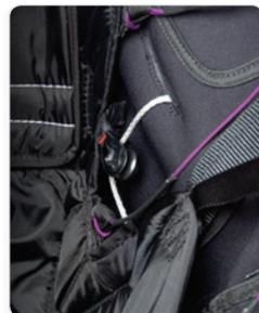
Danach führst du die Leine über das Ronstan Röllchen. Stelle sicher, dass das Röllchen nicht verdreht ist, ehe du die Leine durch die schmale Öffnung in den Pod Raum führst.
