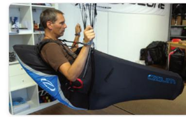
Vor deinem ersten Flug empfehlen wir, dein Gurtzeug an einem geeigneten stabilen Platz aufzuhängen um zu überprüfen, ob es dir korrekt angepasst ist, und dich mit den Features und Einstellungsmöglichkeiten vertraut zu machen. So kannst du für deine Schultergurte und die Rückenunterstützung die beste Einstellungsposition für dich in einer angenehmen, liegenden Position finden.
