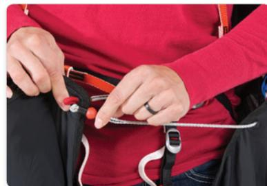
Der rote Ball unter dem Maillon auf der linken Seite sollte nun durch die Schlaufe des „Anti-Forget“ Systems geführt werden.
