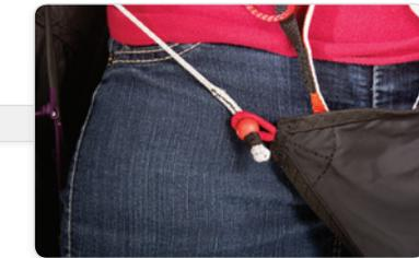
Nun sollte das automatisch schließende Beinsack-System verbunden werden. Verbinde zuerst die rote Schlaufe des linken Pods mit dem roten Ball, der sich unter dem Maillon auf der rechten Seite des Gurtzeugs befindet. Der rote Ball geht durch die rote Schlaufe.
