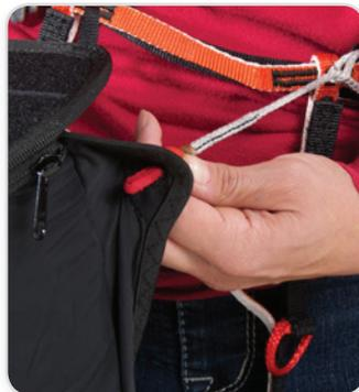
Danach führst du die rote Schlaufe des „Anti-Forget“ Systems durch die Öse auf der rechten Seite des Pods neben der Vorrichtung für die Instrumente.
