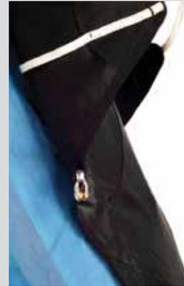
Wenn du eine Speedbar anpassen möchtest, führst du die Leinen des Beschleunigungssystems über die Rolle, die sich an der Seite des Gurtzeugs befindet. Vergewissere dich, dass die Leinen außerhalb der Gurte und Einstellungsrollen verlaufen.
