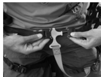
S'assurer qu'aucun tissu ni qu'aucune sangle ou aucun autre objet n'est coincé entre les parties mâles et femelles de la boucle. Toujours s'assurer plusieurs fois que les boucles sont attachées avant de décoller.
