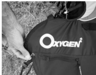
Stelle sicher, dass die Leinen frei durch die Rollen laufen können, außerhalb der tragen den Elemente und innerhalb des Verkleidungsstoffes.
