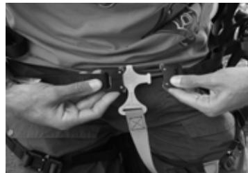
Stelle sicher, dass sich zwischen den beiden Teilen der Schließe kein Stoffstück oder irgend ein anderes Objekt befindet. Bevor du startest solltest du immer mehrere male überprüfen, ob die Verbindung auch tatsächlich fest und sicher geschlossen ist.
