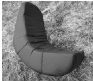
L'O2 est fournie avec une protection mousse de 17cm d'épaisseur. Elle est conçue pour absorber des chocs en laissant l'air fuir aux travers de la mousse, des coutures et du tissu. Mais cela ne remplace pas vos jambes comme le premier moyen d'absorber l'énergie lors d'un atterrissage un peu dur.
