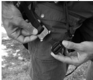
Les cuissardes et les ventrales sont attachées à l'aide de boucles automatiques. A l'accrochage, s'assurer que les parties mâle et femelle s'emboîtent correctement et qu'un clic bien audible se produit.
