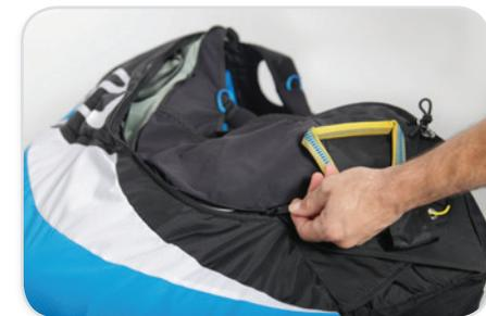
Schließe die 3x Reißverschlüsse, die in den Container hineingehen. Zuerst den, der die Verbindungsleinen sichert, und dann die beiden Reißverschlüsse für das Rettungsschirmfach: einen auf der Rückseite der Tasche und den anderen vorne.
