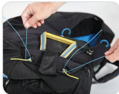
Nun kann das obere Blatt in Position gezogen werden. Der Griff befindet sich hinter der Außenhaut des oberen Blattes und ist mit einem Klett gesichert. Schiebe die Nylon Stifte des Rettungsgriffs durch den Spalt des Materials über den Ösen des oberen Blattes. Ziehe die weißen Schlaufen durch beide Ösen des oberen RG-Deckels (D und 4), und schiebe die Stifte durch die weißen Schlaufen.
