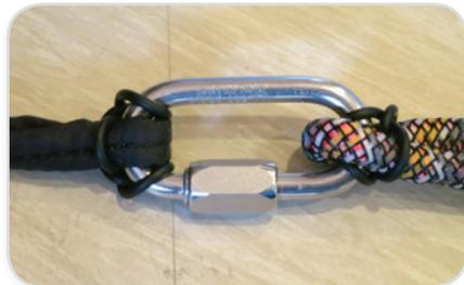
Verbinde die Verbindungsleinen des Gurtzeuges mit denen des Rettungsschirmes mit Hilfe eines geeigneten Verbinders (Schraubkarabiner etc. sind nicht im Lieferumfang enthalten).
