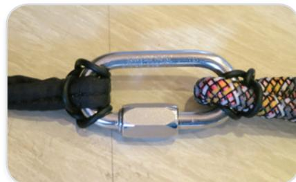
Reliez les brides de la sellette à celles du parachute de secours en utilisant un dispositif de connexion ad hoc (non fourni).
