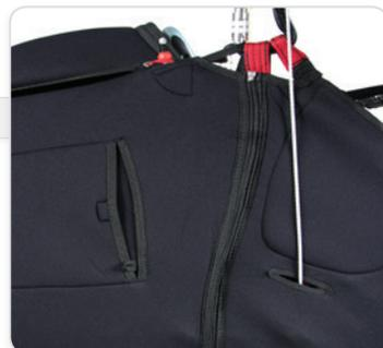
Puis passez le cordon par la poulie Ronstan, en veillant bien à ce que le cordon ne soit pas torsadé avant de le passer par le compartiment du pod.
