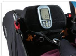
Le cockpit fait partie intégrante de la sellette. Les appareils peuvent être fixés directement dans le cockpit ou bien sur la planche inclinée à Velcro. En vol, le cockpit se positionne au-dessus de la sangle de poitrine, pour une lecture parfaite des instruments.
