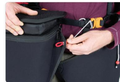
Passez ensuite la boucle rouge du dispositif anti-oubli par l'oeillet situé sur le côté droit à côté du cockpit.
