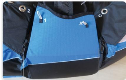
Le container peut être fermé en tirant sur les deux fermetures éclair en direction des oeillets, puis en les faisant revenir en dessous de la sellette afin de les y loger.
