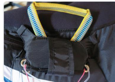
Le pan du haut peut à présent être rabattu. La poignée de largage est positionnée à l'extérieur du tissu de ce pan supérieur. Passez les goupilles en nylon de poignée par les espaces du tissu juste au-dessus des oeillets du pan supérieur.
