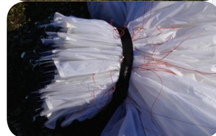
**Schritt 1.** Lege deinen zusammengerafften Flügel auf den Saucisse Pack. Das ist die beste Ausgangsbasis um zu vermeiden, dass die Anströmkante unnötig über den Boden gezogen wird. Das Schleifen über den Boden kann durch die Plastikverstärkungen Schäden an der Segeloberfläche verursachen.
