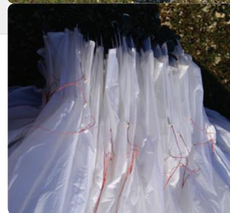
**Paso 4.** Agrupa el centro/borde de fuga de la vela ordenando los pliegues cerca de los puntos de anclaje de las B, C y D.
