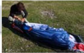
**Schritt 9** Drehe die Saucisse auf die Seite und falte den Schirm zum ersten mal nach den Verstärkungen der Anströmkante. Falte nicht die Plastikverstärkungen. Falte den Schirm 3 oder 4 mal um die Anströmkante herum.
