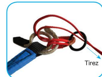
Faites passer une seconde fois la boucle **B** par les élévateurs en suivant le même cheminement que la première fois. Une fois que la boucle **B** est passée une seconde fois et qu'elle est en position correcte, tirez sur les suspentes pour forcer l'anneau en caoutchouc à se mettre dans la bonne position.
